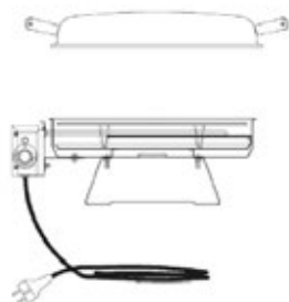
Hinlegen des Rosts über das Tropfblech
